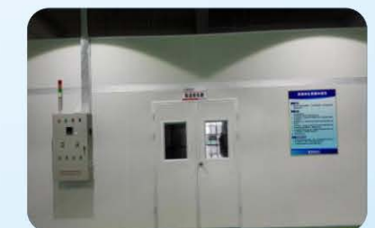
高温老化房 -LA-ORT93 6m×5m×2.2m 常温+5℃~60℃ 口台湾(宣荣)H961温度控制仪
