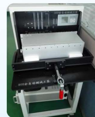
自主研发的DTU 全自动测试工装
